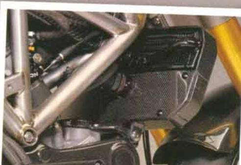
La radiateur d'huile est en fibre de carbone.
