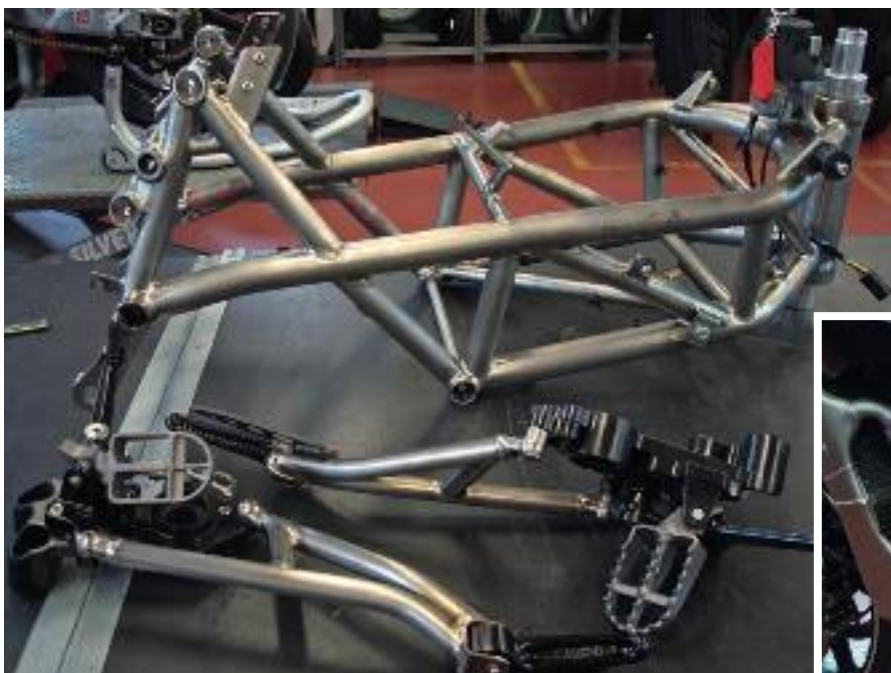
Telaio e gruppo pedane NCR pronte per essere assemblate.
