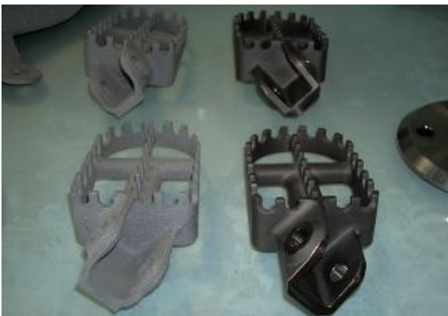
■ Pedane prototipo realizzate in sinterizzato di alluminio e il prodotto definitivo in titanio.
