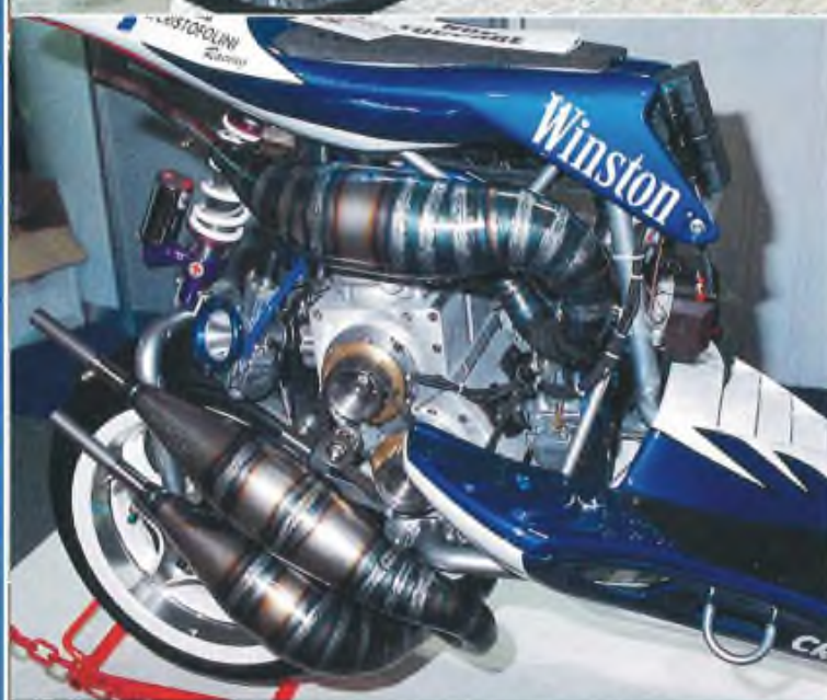
Super-Scooter: 350 ccm, Zweitakt-Vierzylinder, 112 PS. Mut zu Vollgas?
